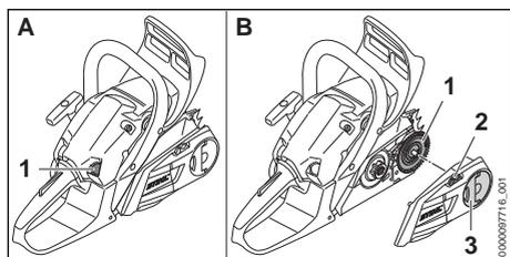
**Pompe d'amorçage manuelle (A)****1 Pompe d'amorçage manuelle**
